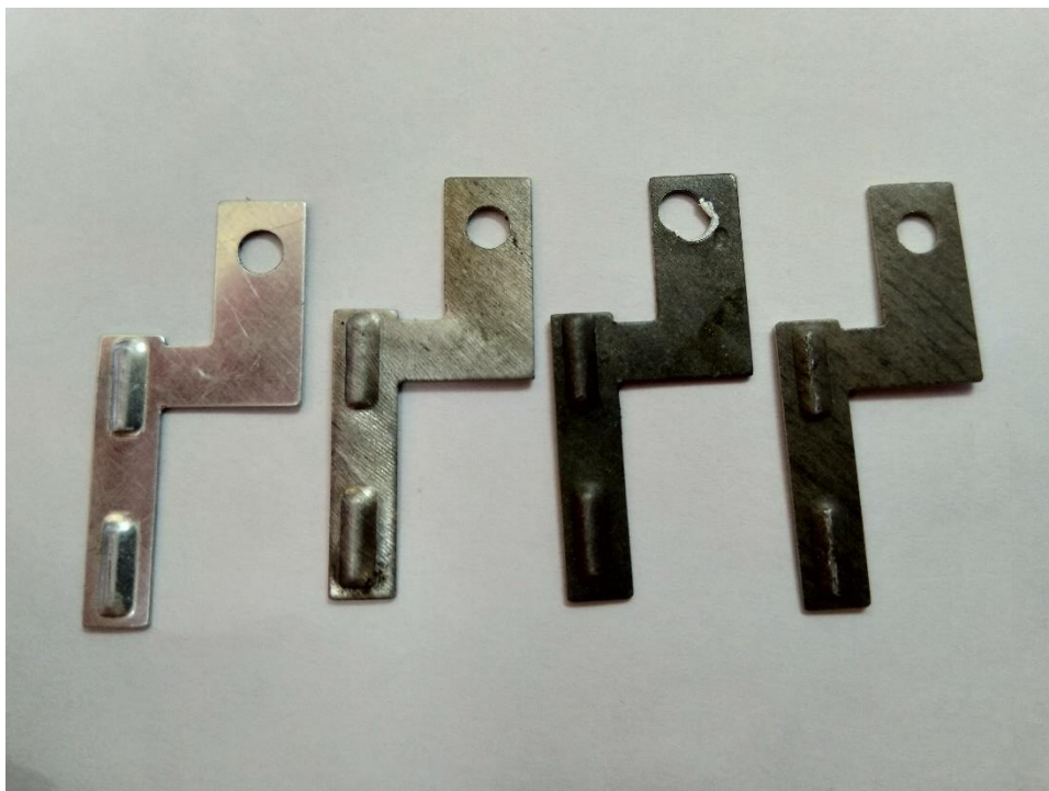
شکل ۳-۶- قطعه ال بلند تولید شده از آلومینیوم؛ از راست به چپ نمونه‌های 7075-O، 7075-T4-1، 7005-W و 3105-O.
