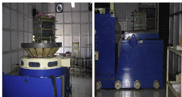
شکل ۸. آزمون ارتعاش در پیل سوختی پلیمری [۱۴۰].
